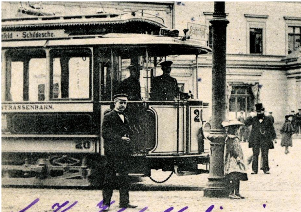
Ein Triebwagen der „Elektrischen“ vor dem früheren Gebäude des Hauptbahnhofes vor 1910: Der Fahrer stand noch ohne Frontverglasung an der „Kurbel“. Der Fahrtzielanzeiger ist gut oberhalb der Fahrgastkabine zu erkennen. Foto: Sammlung Joachim Wibbing/Mobiel
